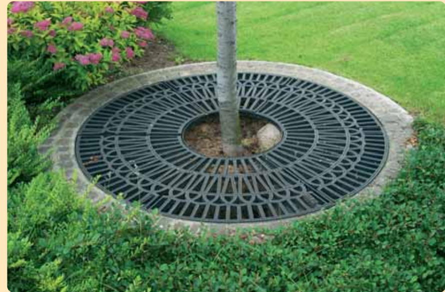
Baumscheibe rund, in sechs Segmenten gegossen Art. B1-1500500: Außenmaß: 1500 mm, Innendurchmesser: 500 mm Art. B2-1800900: Außenmaß: 1800 mm, Innendurchmesser: 900 mm
