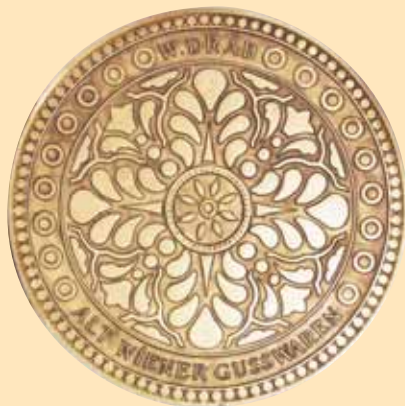
Schachtabdeckung mit Einbauring Art. 19615: Deckel \varnothing 500 mm, Ring \varnothing 590 mm, H: 80 mm, Deckel 26 kg, Ring 36 kg: Bronzeguss Art. 19620: Deckel \varnothing 600 mm, Ring \varnothing 720 mm, H: 130 mm, Deckel 85 kg, Ring 60 kg Sichtseite Bronzeguss, Unterseite Grauguss Art. 19616: Deckel \varnothing 675 mm, Rahmen 500 x 500 mm, H: 90 mm, Deckel 26 kg, Rahmen 60 kg, Deckel und Rahmen aus Bronzeguss, begehbar und Pkw befahrbar, ohne Prüfzeichen
